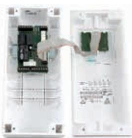
Modello con relè aggiuntivo da 3Hp (30A) per il compressore per aumentare la capacità frigorifera\*
